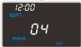
2) Обратный отсчет в режиме наполнения. Время наполнения – около 4-5 минут. Пожалуйста, обратите внимание, как идет наполнение. После завершения этапа наполнения система автоматически переходит в режим растворения соли
